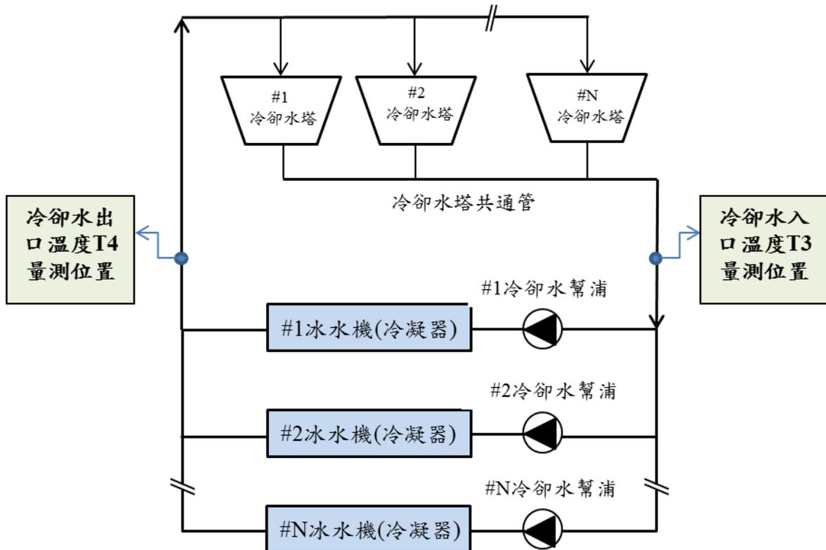
圖二 冰水機冷卻水出水、回水溫差量測位置
