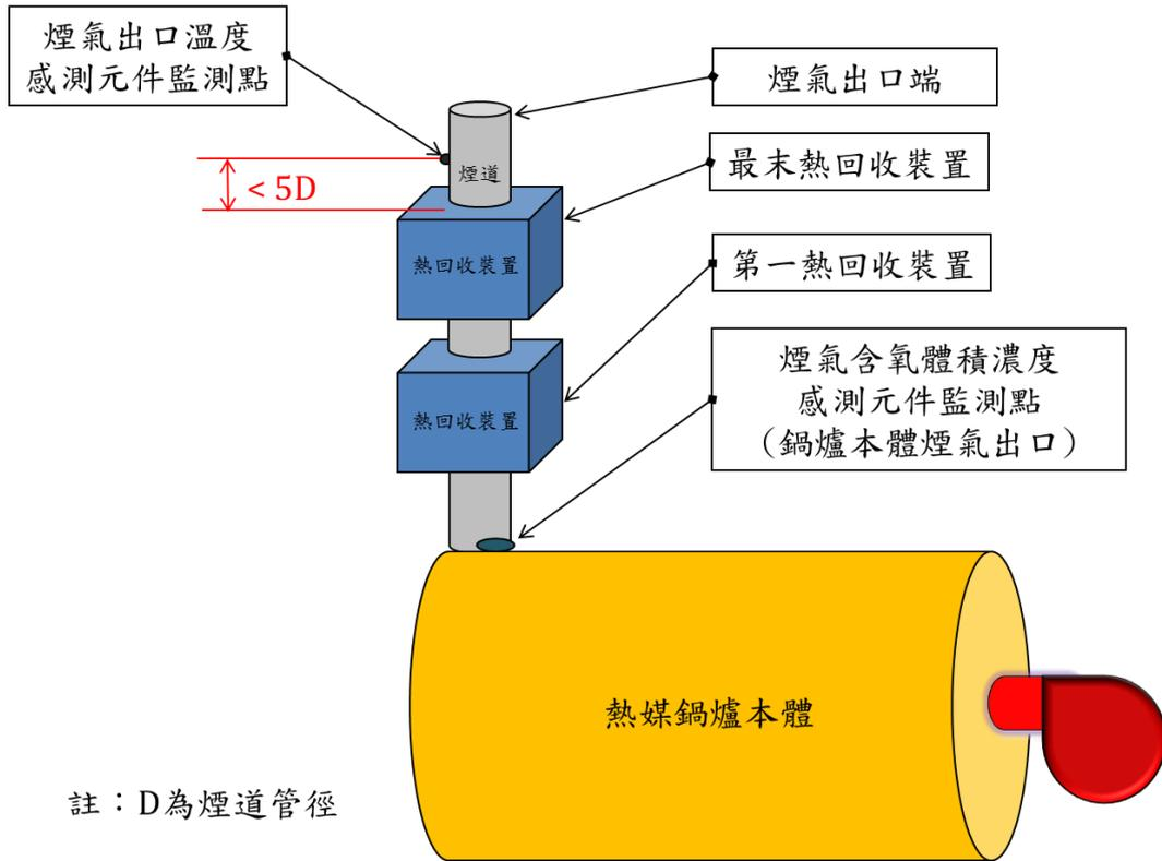
圖二 熱媒鍋爐（已設有熱回收裝置）煙氣含氧體積濃度及煙氣出口溫度之監測點
