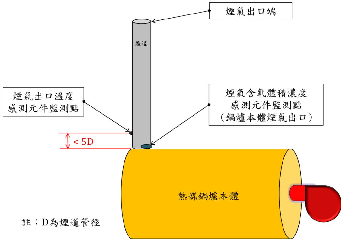
圖一 熱媒鍋爐（未設有熱回收裝置）煙氣含氧體積濃度及煙氣出口溫度之監測點
