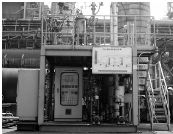
圖3-8-7 業界100kg/天二氧化碳捕獲實驗系統
