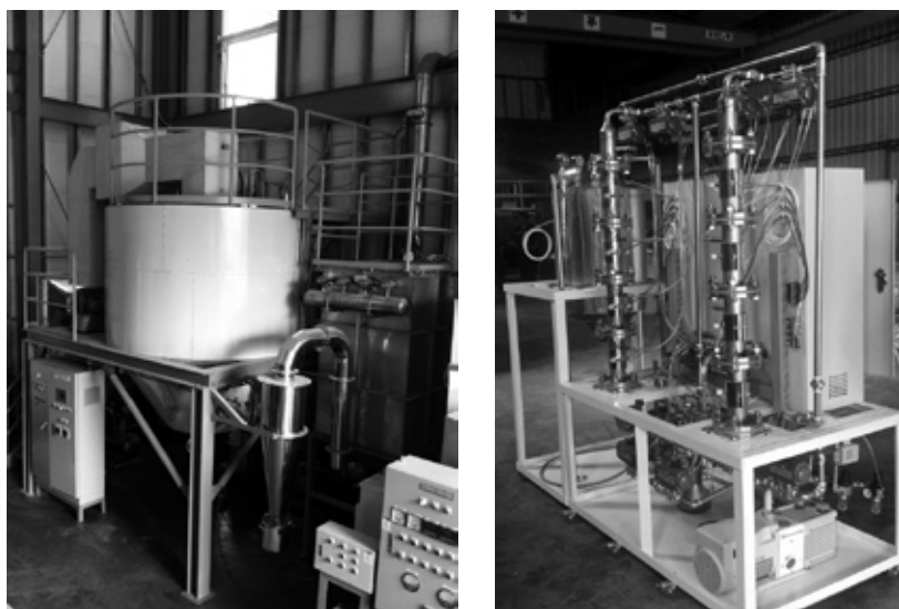
圖3-8-6 中孔徑矽基吸附材量產與吸附系統
