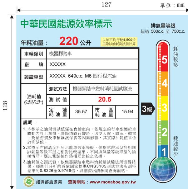
圖二、機器腳踏車能源效率標示樣本
