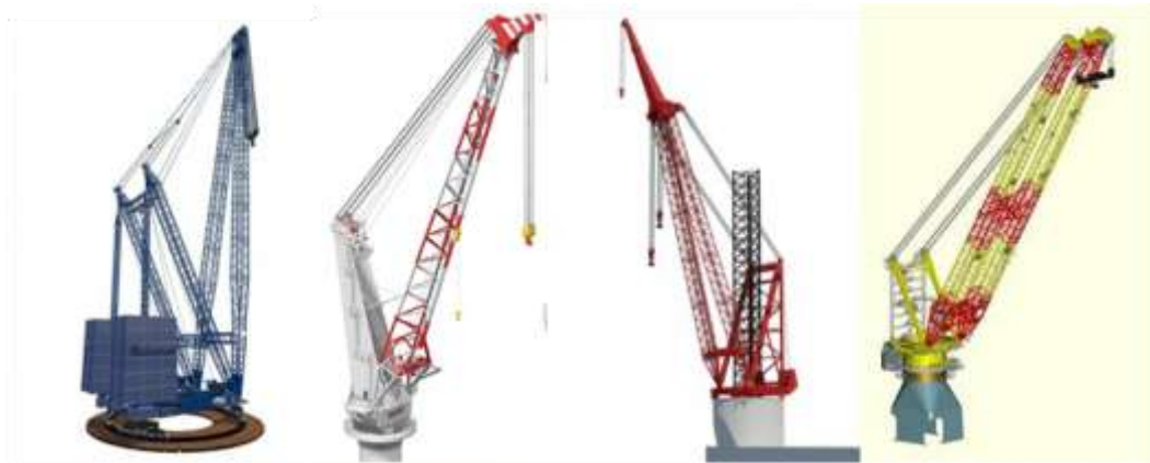
圖 73 Ringer Crane、Mast Crane、Round-Leg Crane-1、Round-Leg Crane-2。
