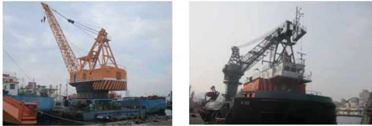
圖 74 穩晉、基隆港務局現有的吊車船之舉吊能力不足以符合風電所需。
